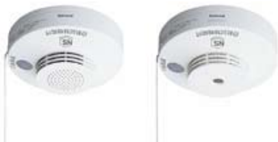
設置しなければならない箇所は、寝室や寝室へ向かう階段の上端(煙感知器:左、熱感知器:右)
